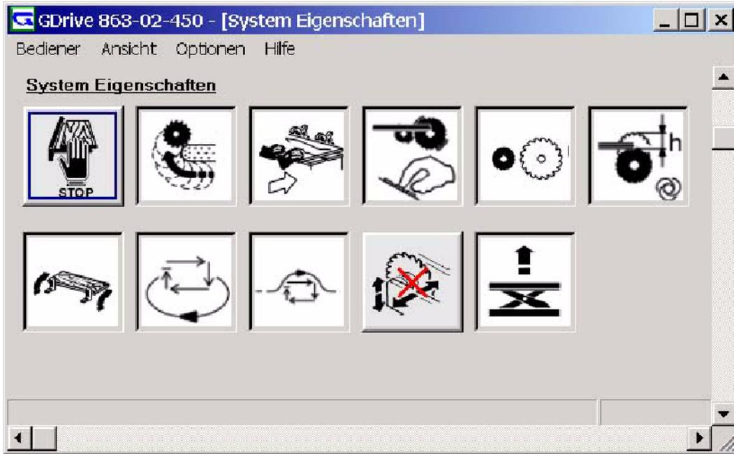
Die verfügbaren Optionen sind vom Maschinentyp abhängig. Jeder Button kann mit den Pfeiltasten oder mit der Plustaste auf der Zahlentastatur aktiviert bzw. deaktiviert werden.
